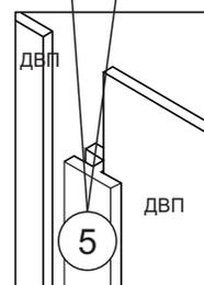
Схема крепления соедин.элемента
